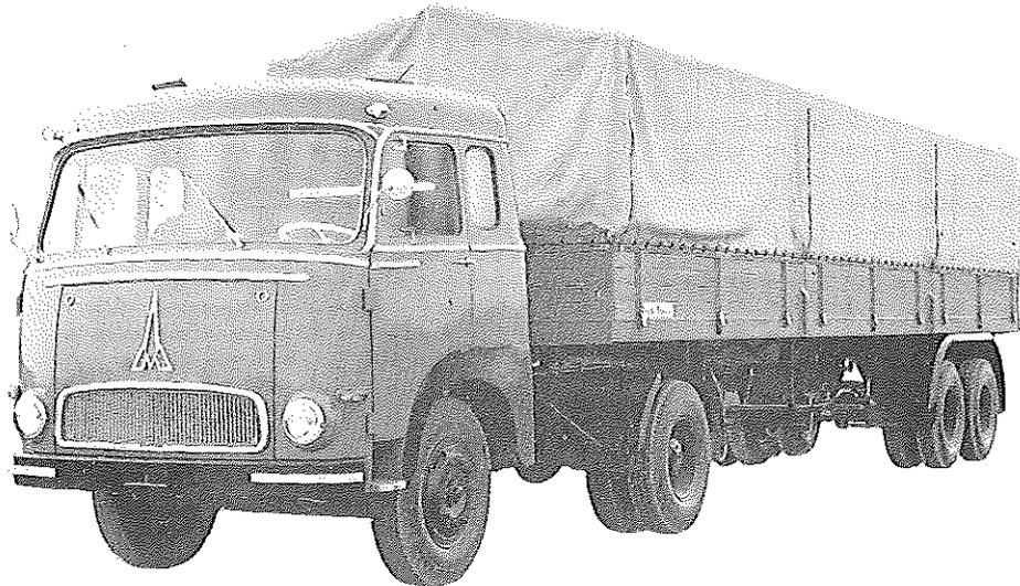
**Diesel-Motor · 6 Zylinder · 4-Takt · 150 PS bei 2300 U/min**
